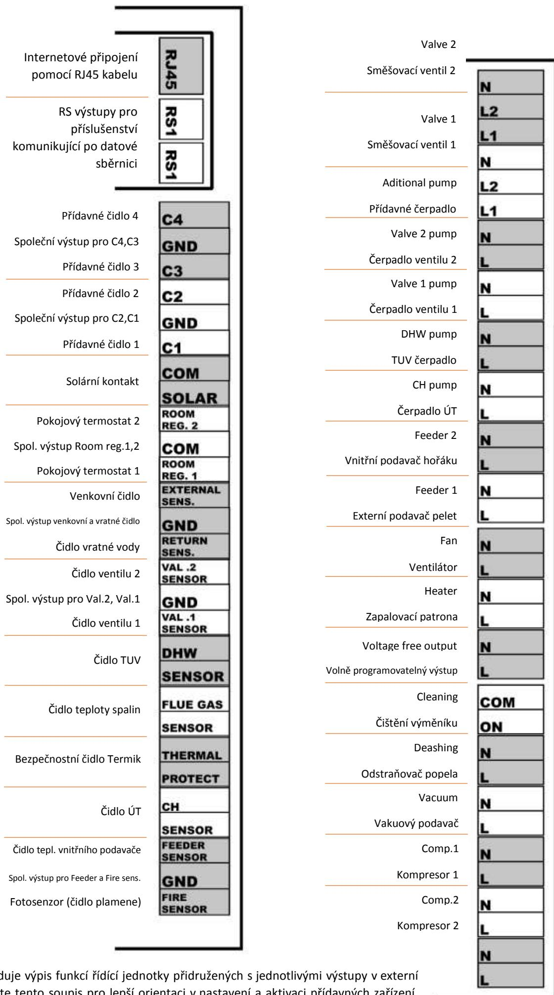
Následuje výpis funkcí řídící jednotky přidružených s jednotlivými výstupy v externí
