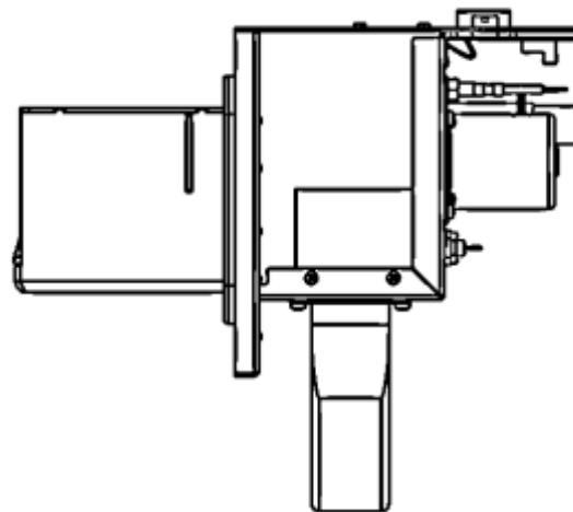
Osinková těsnící šňůra musí vždy těsně doléhat na kotel, respektive přírubu hořáku na kotli tak, aby nedocházelo k úniku kouře a tepla ze spoje ven do místnosti. V opačném případě by do místnosti unikaly zplodiny z hoření a hrozilo by riziko poškození komponentů kotle a riziko požáru.
