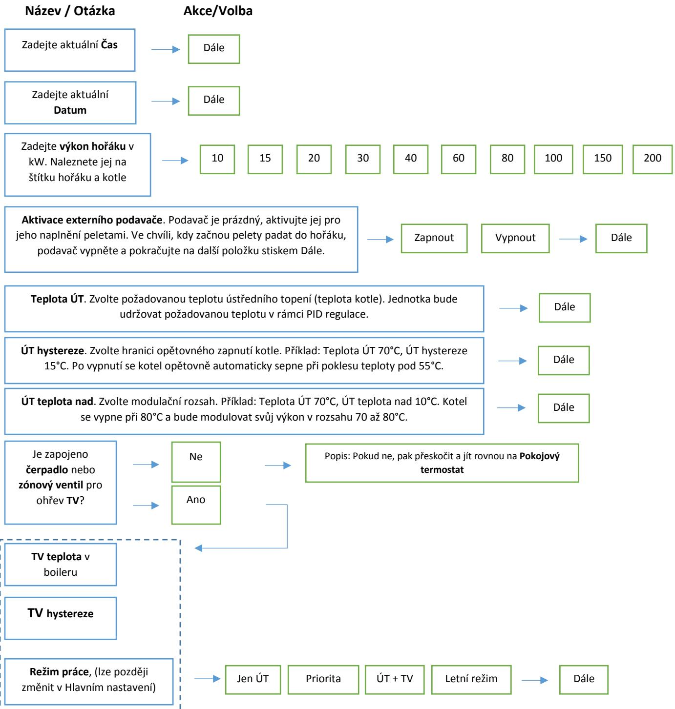
Následuje aktivace zapojených přídavných zařízení do výstupů 230V a datových RS. Pokud aktivujete příslušenství, ke kterému je přiřazeno některé z čidel, tyto čidla musí být také zapojeny, jinak bude po aktivaci zobrazeno chybové hlášení. Tovární nastavení aktivovaných přídavných zařízení můžete vždy změnit v Instalačním menu.
